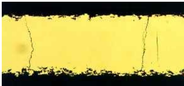
Afbeelding 4: Dwarsdoorsnede testplaat N, sterke aantasting en SCC na blootstelling aan ammonia-buffer gedurende 32 dagen.
