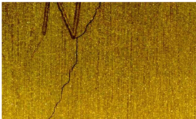
Afbeelding 3: SCC in messing a.g.v. blootstelling aan ammonia-oplossing (20x vergroting) 83
